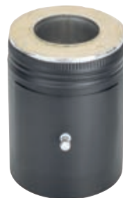
SPJÄLLMODUL Rökgasspjäll för att förhindra kallras. Ytermått: Ø 280 mm Bygglängd: 300 mm
